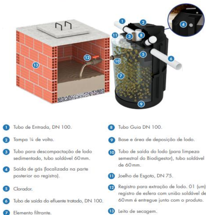
Figura 2 - Composição do Sistema de Tratamento de Esgoto
