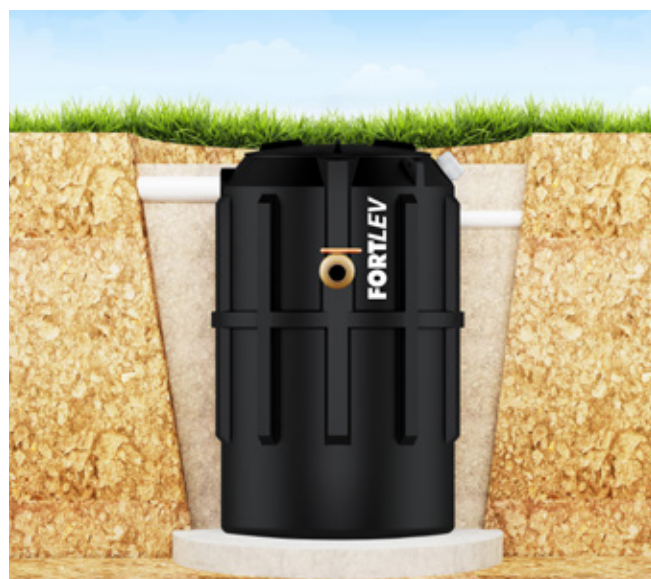
Figura 8 – Aterro completo com compactação.
