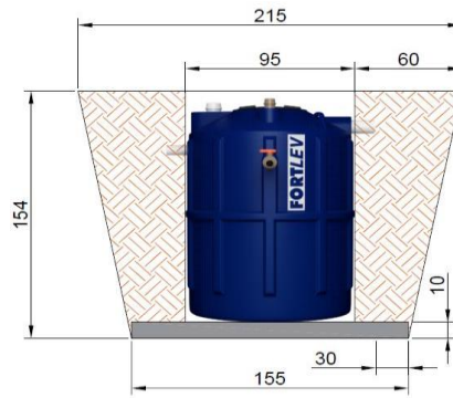
Figura 4 - Modelo de Escavação
