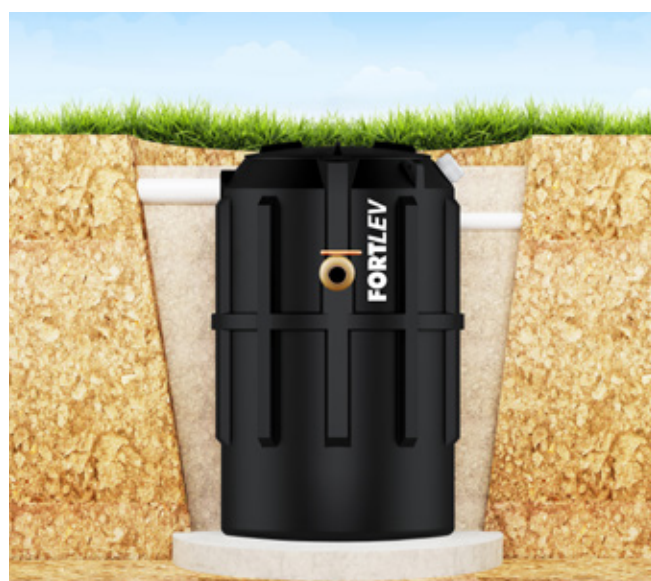
Figura 8 – Aterro completo com compactação.
