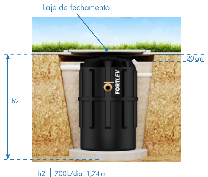
Figura 4 – Instalação com laje de fechamento.
