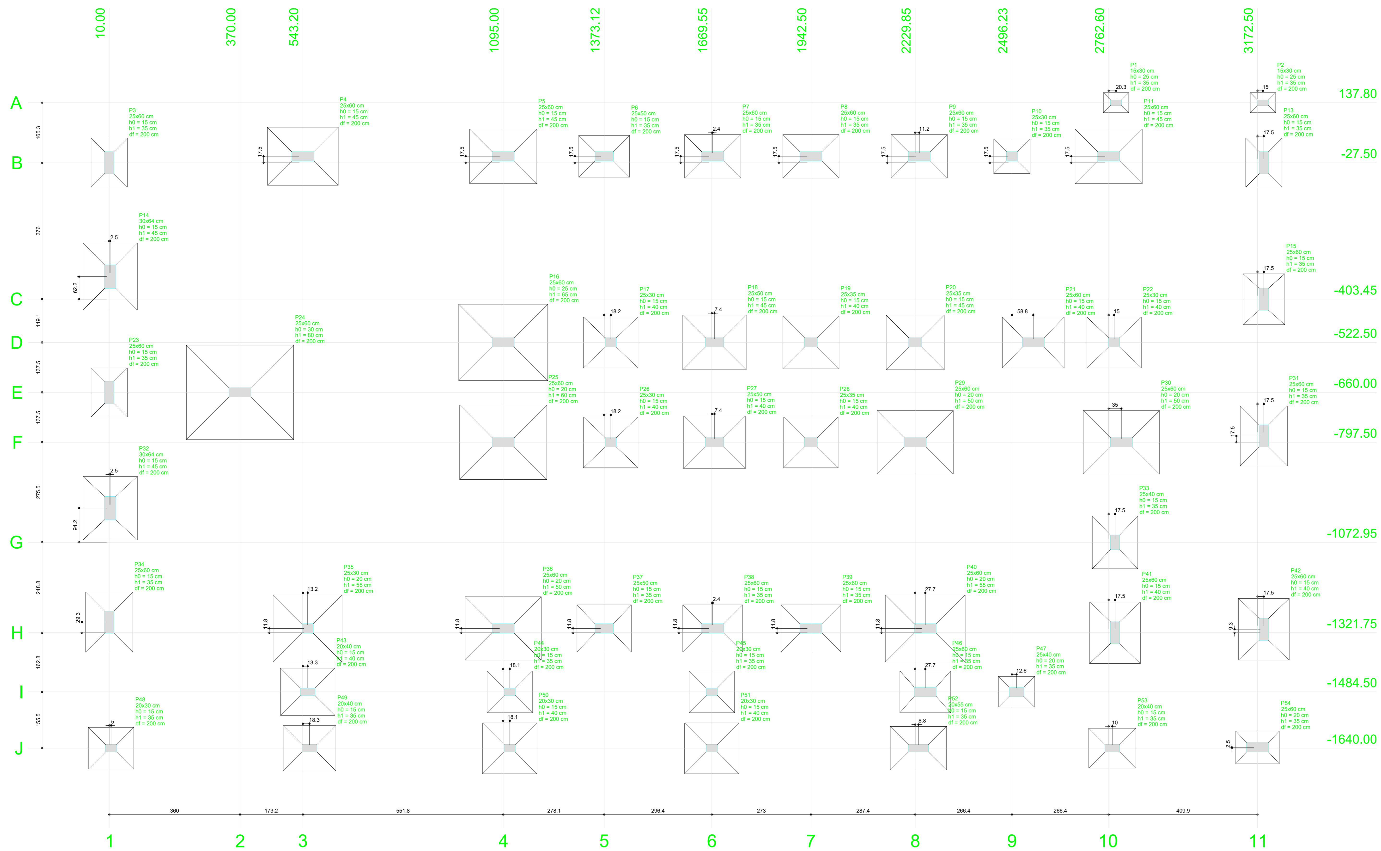
LOCALIZAÇÃO DOS PILARES E SAPATAS NA FUNDAÇÃO ESCALA 1:50
