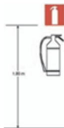
Figura 3 - Sinalização de extintores
