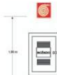
Figura 4 - Sinalização de hidrante
